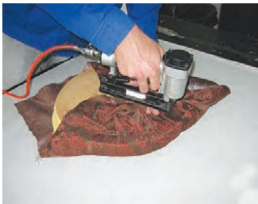
شکل ۱۱۷- منگنه زدن چهارطرف و ثابت کردن پارچه
