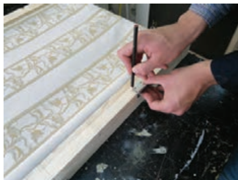
شکل ۶۸- خط کشی با استفاده از لولا
