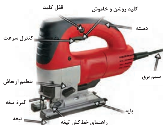
شکل ۴۰- قسمت‌های مختلف اره عمودبر
