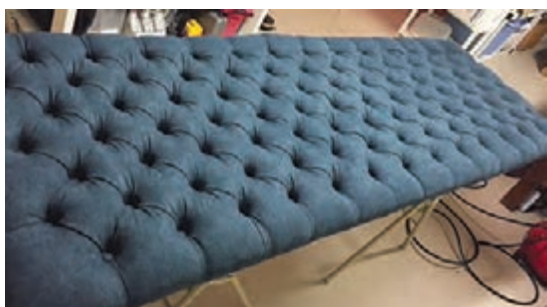
شکل ۷۱-لمسه کاری کامل دیوارپوش تزئینی
